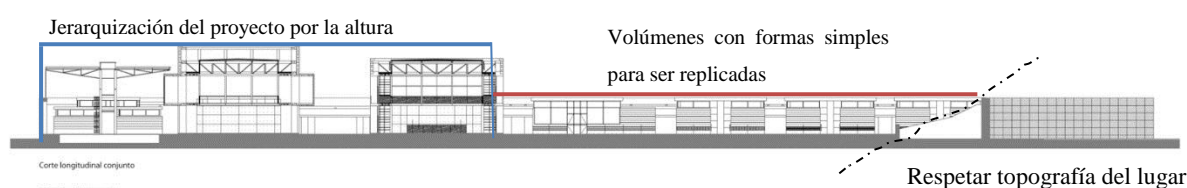
Ilustración 28. Referente arquitectónico 2: corte general.
