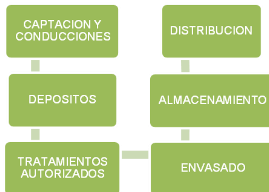
Figura 5. Proceso de producción del agua envasada.
