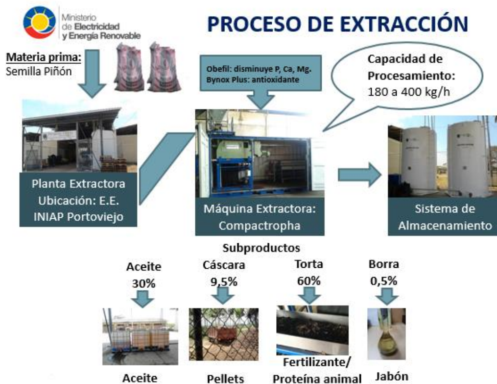
Gráfico 15. Proceso de Extracción – Planta COMPACTROPHA Fuente: MEER, 2015
