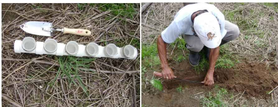
Fotos 3 y 4: tubo de PVC que fue enterrado para recolectar agua lixiviada.
